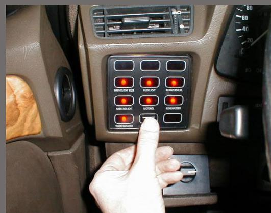
Test der CheckControl-Funktionen per Tastendruck
